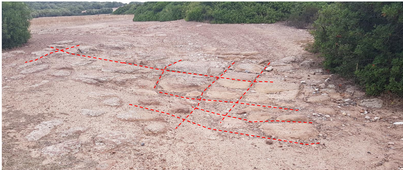
Figura 5.7 Rioliti di Seruci in affioramento e relative discontinuità
