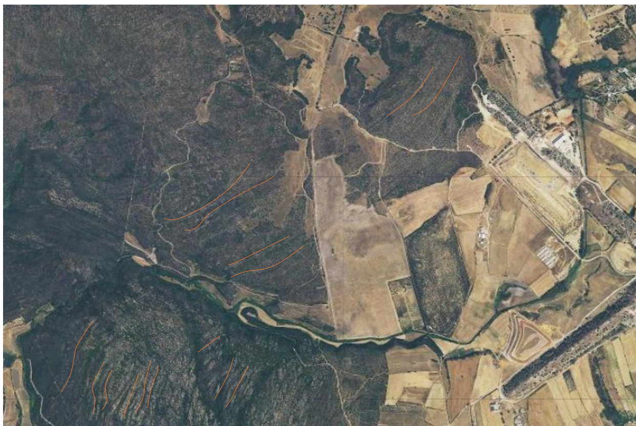
Figura 5.5 - Foto aerea dell'area e superfici di discontinuità dell'ammasso roccioso
